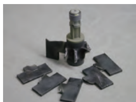
メーターの仕様をはるかに超え、過酷な使われ方で使用された羽根車の破損
