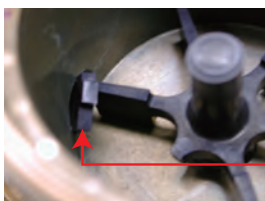
羽根車の羽根が折れ、羽根車の羽根外周と下ケースの内壁面（出口側ノズル）の間に噛み込み
