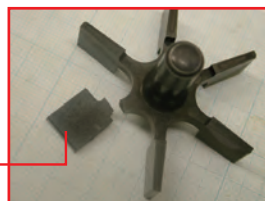
メーターの仕様を超えた使われ方で使用された羽根車の破損
