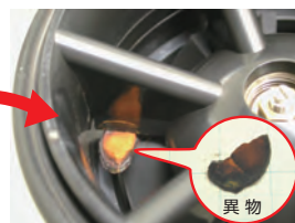
羽根車と整流器に噛み込んでいた異物
