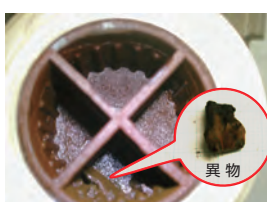
ストレーナーに異物が付着して流速に影響
