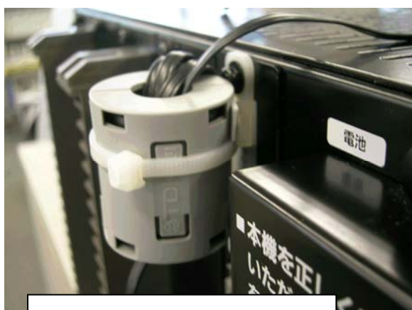
電話回線用ケーブルの取付イメージ
