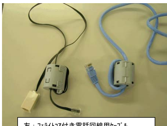
左：フェライトコア付き電話回線用ケーブル 右：フェライトコア付きLAN用ケーブル
