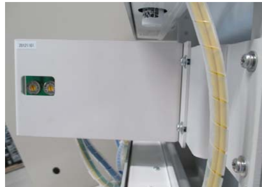
図2. 図1を矢印A側から見た図 (左: 零調整トリマ、右: スパン調整トリマ)
