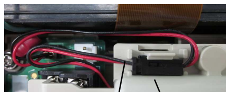
リード線はフタで挟み込まないようにこの写真の通り引き回します。
