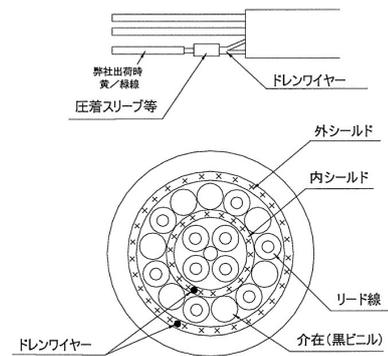
図28. ケーブル端末処理図
