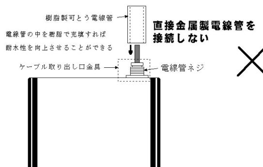
図29. 電線管の接続によるケーブル保護
