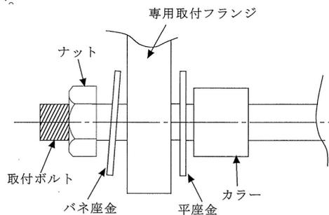
図26. 取付ボルト・付属品の取付
