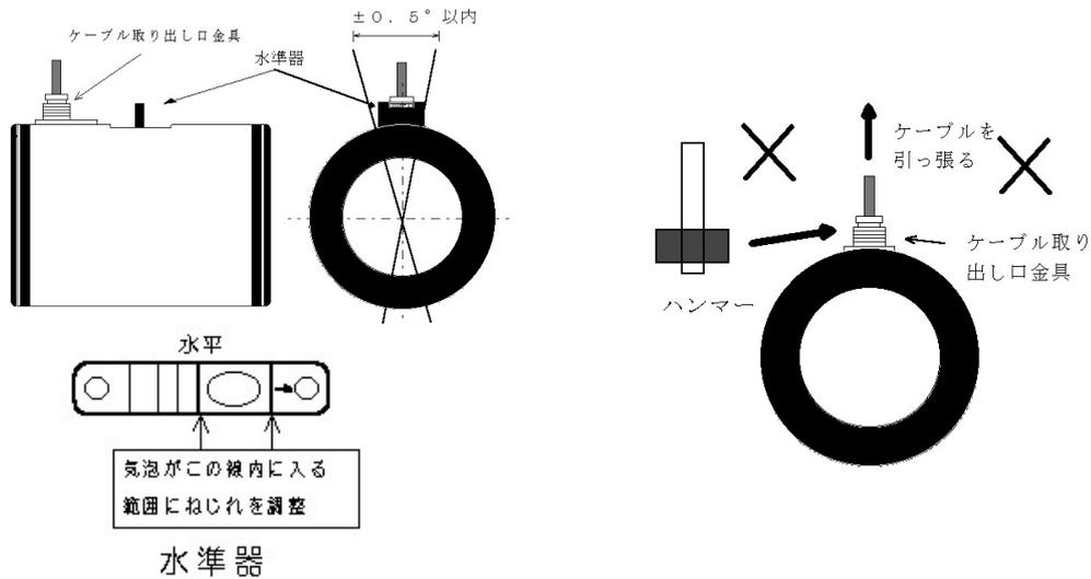
図25. a ねじれの調整・確認方法
