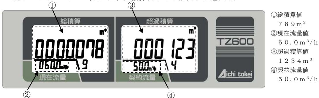
↓ 表示切替スイッチ押下（①表示のみ切替わり）
