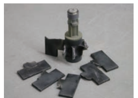
メーターの仕様をはるかに超え、過酷な使用方で使用された羽根車の破損
