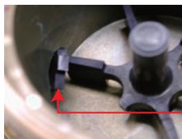
羽根車の羽根が折れ、羽根車の羽根外周と下ケースの内壁面（出口側ノズル）の間に噛み込み
