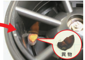
羽根車と整流器に噛み込んでいた異物
