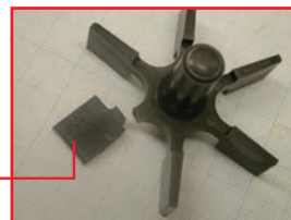
メーターの仕様を超えた使用方で使用された羽根車の破損
