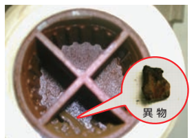
ストレーナーに異物が付着して流速に影響
